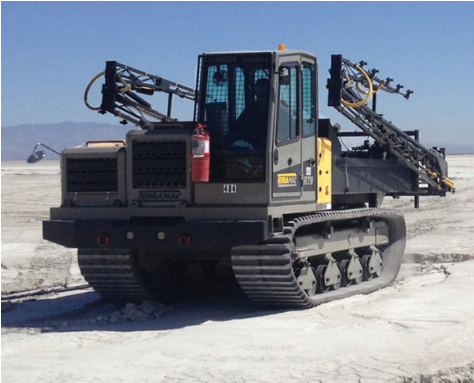
Dust Suppression Unit
