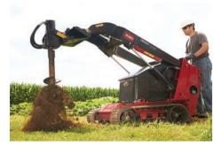
**HIGH-TORQUE AUGER POWER HEAD** 22805
