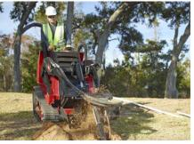
**HIGH-TORQUE TRENCHER HEAD** 22473
